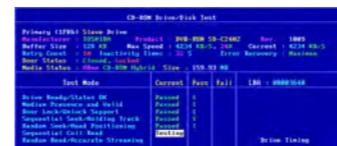
アプライドの国内自社工場で生産されるパソコンはすべて、業界標準検査の「QuickTech Professional」による診断を行っています。CPU、Memory、HDDなどコンピュータを構成する各ハードウェアに対し、実際に稼動しているときと同じ状態を作りだし、負荷をかけます。それぞれのハードウェアに対し、個別の強力な診断プログラムが用意されています。(※例えば、メモリの診断では定評あるメモリ診断アルゴリズム「Jump」をはじめ、6種類の診断アルゴリズムを駆使してエラーを検出します。)こうして、ソフトウェア的に負荷をかけることにより、従来の診断ツールでは発見できなかったエラーの検出も可能になりました。この「QuickTech Professional」で診断された結果を「診断書」として製品に添付いたします。これが、「品質合格の証」です。
