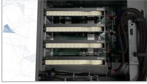
グラフィックボードを4基搭載してもゆとりのある構造で、処理能力と高い冷却性を両立することができます。ハイエンドクラスのGPUを複数採用することで、ローカルでの大規模処理が可能になります。
