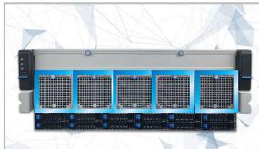
イージースワップとは、欠陥のある部品を簡単に交換できるようにすることで、システムのダウンタイムを最小限に抑えることができる仕組みです。5基もの圧倒的な冷却性を発揮するファンを、いつでもメンテナンスすることも可能です。
