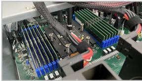
最新のDDR5メモリで、最大5,600MT/sの高速化に対応し最大1.5TB(128GB x 12)を実装できます。さらにメモリはレジスターチップとECCを搭載しているため、長時間の利用やもしもの時のエラー時も安定した動作が可能です。
