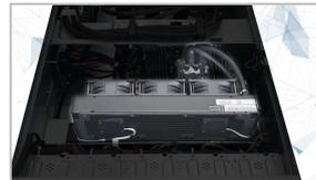
MSI独自の技術により、非常に限られたスペースでも最大限の冷却性能を発揮する水冷CPUクーラーを搭載することができるようになりました。ハイエンドマシンのCPUとGPUは大きな熱を持つため、高い冷却性能が必須となります。
