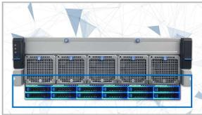
ホットスワップとは、機器の電源を入れたまま、部品やケーブルの交換を行う機能や仕組みのことです。フロントのカバーを開くと12基のNVMeベイが現われ、もしもの時にエラーが見つかったりも簡単に交換することが可能です。
