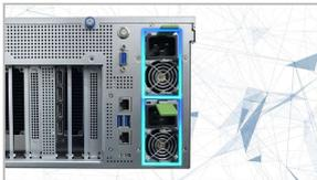
通常は電源が故障するとパソコンの電源が落ち、ファイル喪失やシステムエラーのリスクを被りますが、電源を2つ搭載していればもしもの時の故障時も業務が止まることはなく、また交換も容易にすることが可能です。
